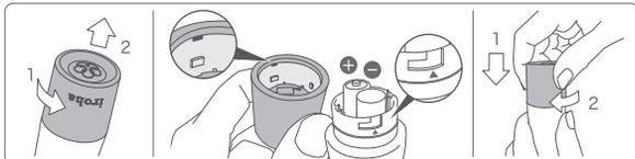
●電池が勢い良く飛び出す恐れがありますので、キャップを上にした状態でボディから外してください。●キャップ内部は触らないでください。基板部に触れるとサビや導通不良、破損の原因になります。●電池の交換は必ず電源をOFFにした状態で行ってください。●ご使用方法や使用頻度により製品の寿命期間が異なります。※故障以外の原因で製品が動かない、振動が鈍い等の症状が出た場合は電池の交換をお勧めいたします。
